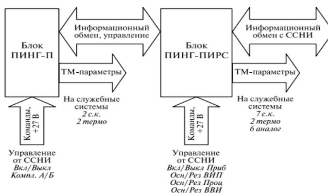
Рисунок 1.7 – Функциональная схема прибора «Пинг – М»
