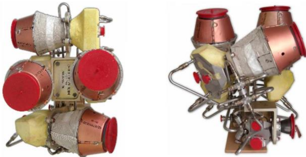
Рисунок 29 – Размещение ЖРД на блоке двигателей малой тяги
