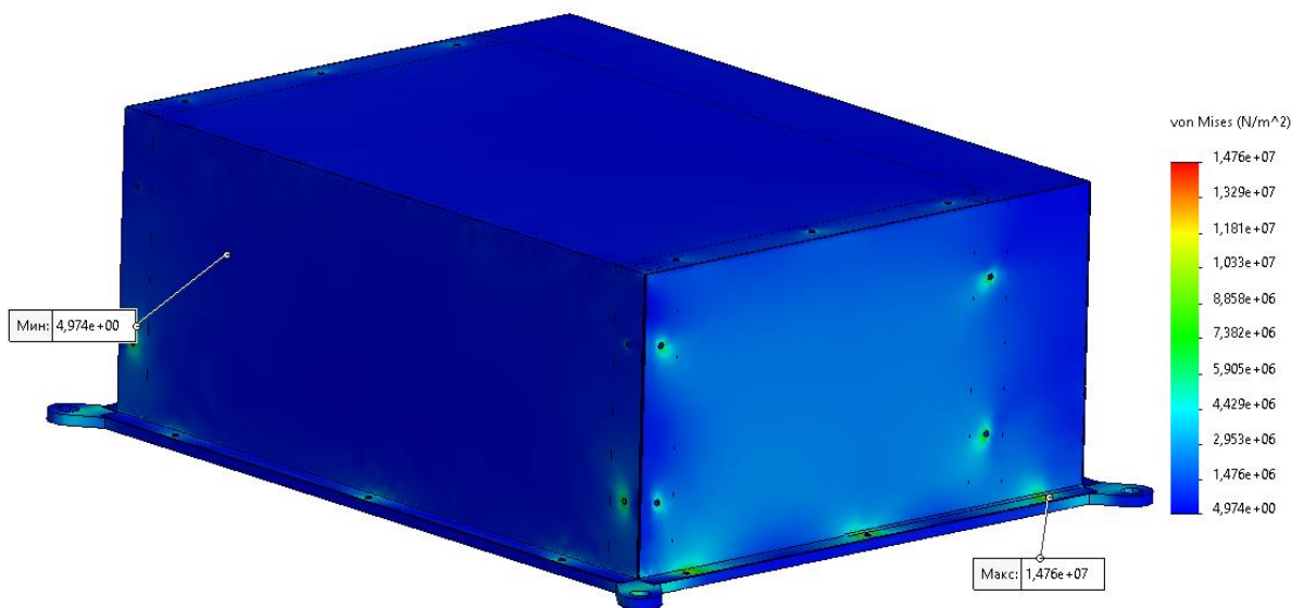
Рисунок 49 – Распределение напряжений в АБ при перегрузке по оси OZ
