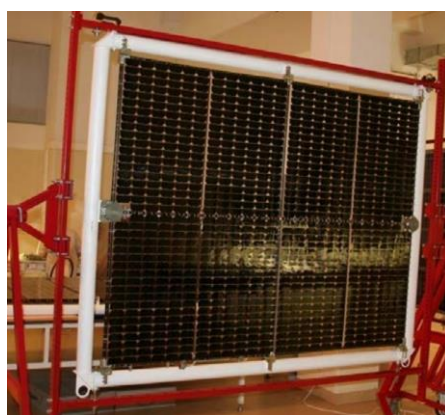
Рисунок 36 – Общий вид СБ на трубчатой конструкции
