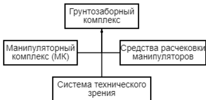
Рисунок 25 – Схема грунтозаборного комплекса
