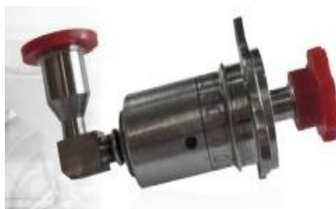
Рисунок 1.14– Внешний вид газового ракетного двигателя малой тяги МД08–02 [13]
