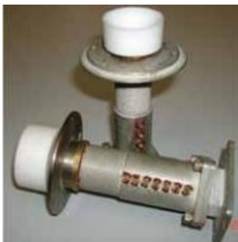
Рисунок 1.21 – Внешний вид малонаправленных антенн, установленных на ПМ [7]
