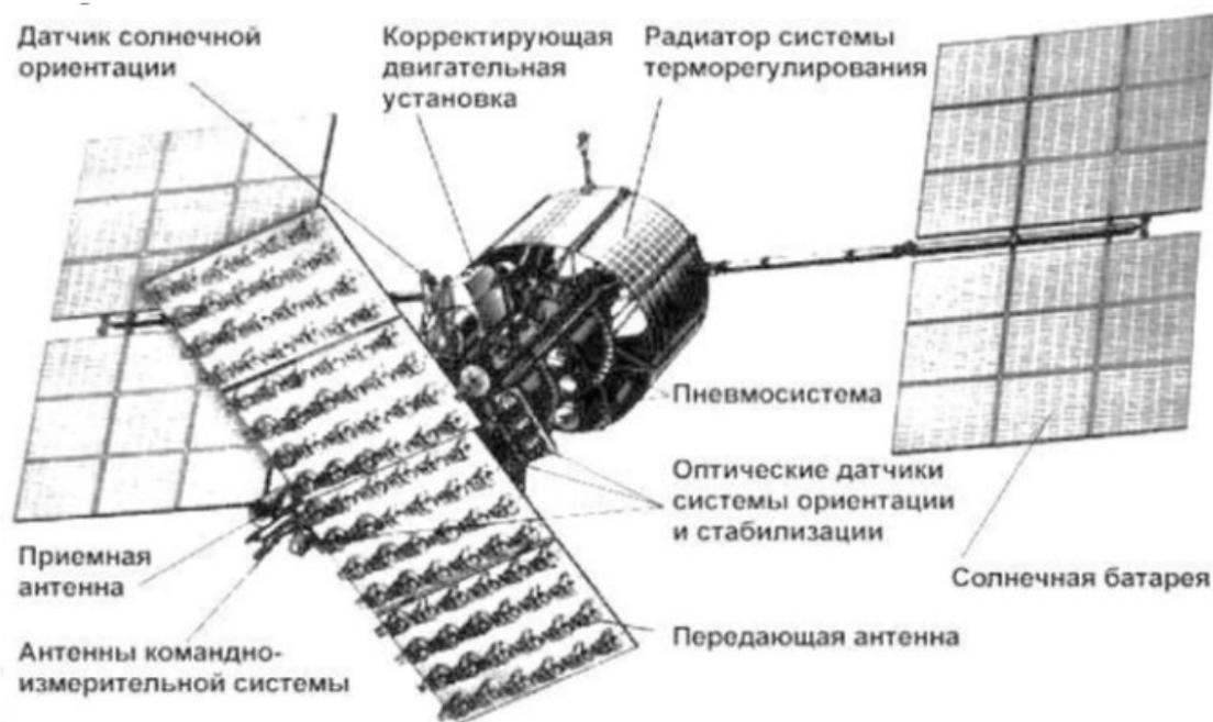
Рисунок 2 – Схема узлов спутника
