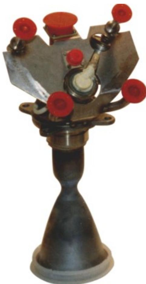
Рисунок 11 – Экспериментальный двухкомпонентный ракетный двигатель малой тяги РДМТ50М
