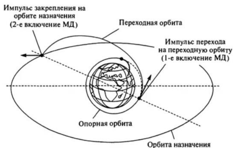
Рисунок 1.8 – Схема некомпланарного двухимпульсного перелета
