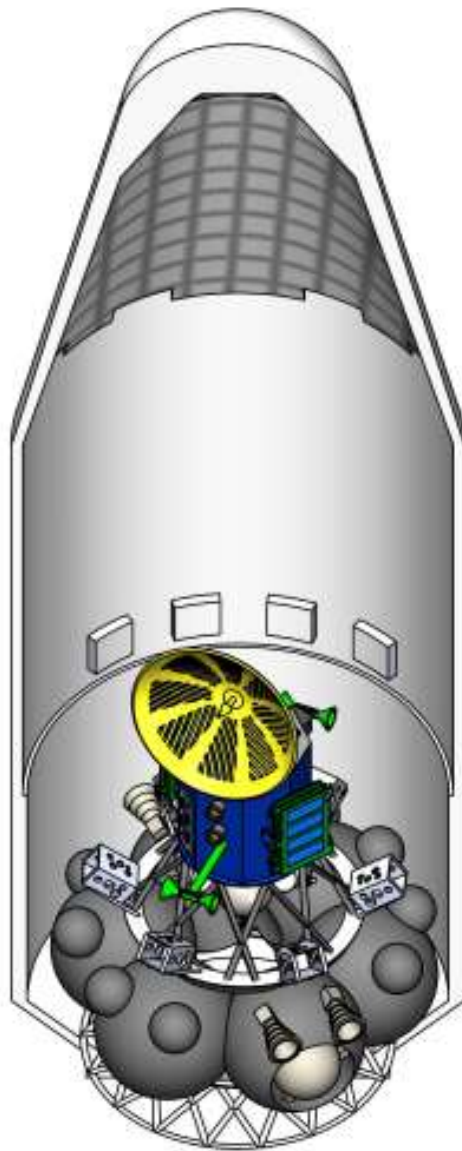
Рисунок 4.15 – Крепление транспортно-пусковых контейнеров для спутников формата CubeSat 12U
