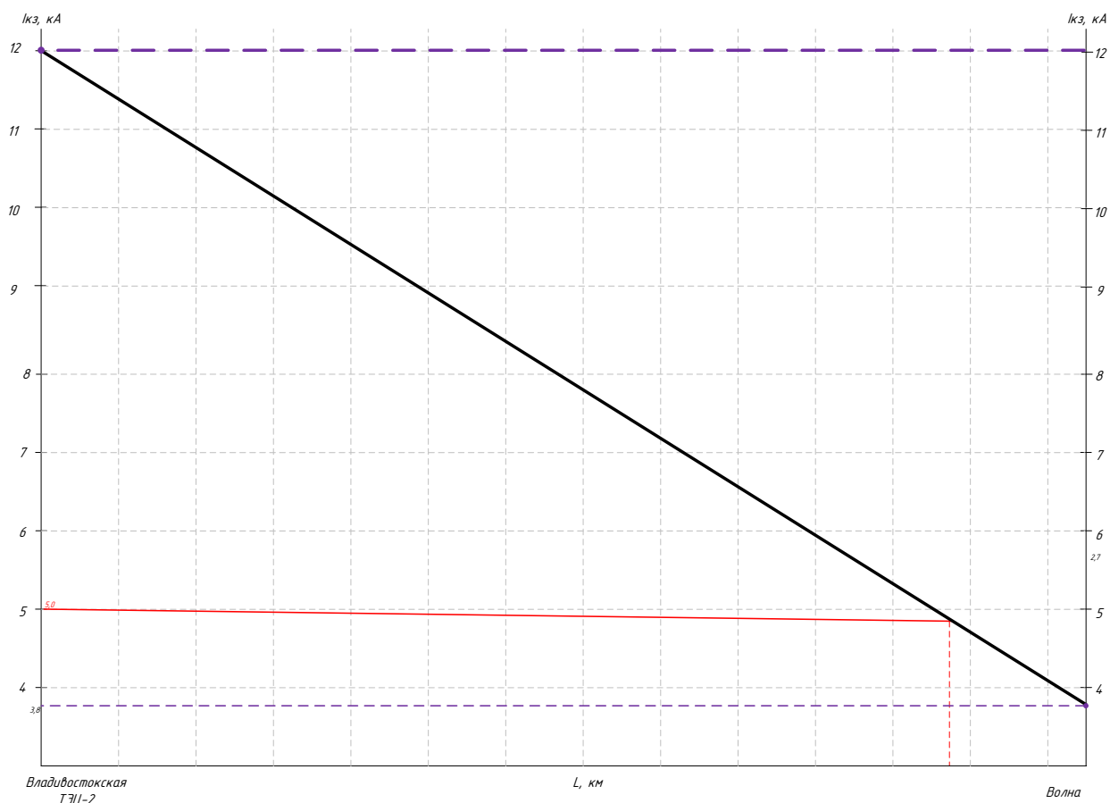
Рисунок 5.1 – Кривые спада тока 3-фазного КЗ для определения чувствительности МТО
