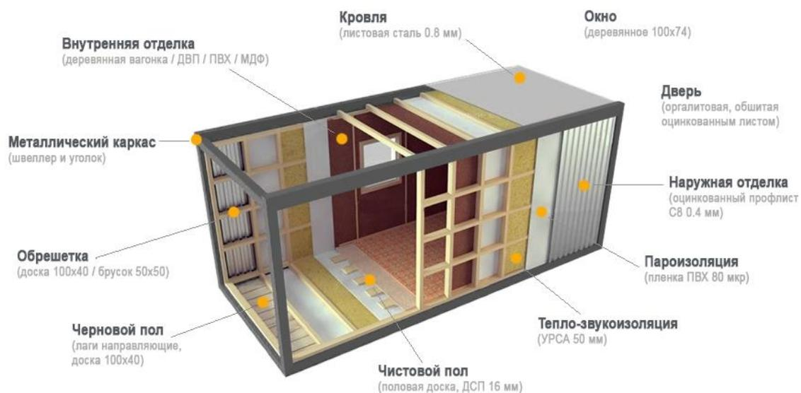
Рисунок В.5 – Конструкция из грузового контейнера 20 футов
