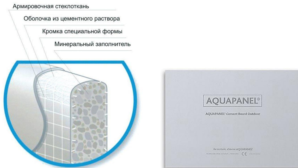
Рисунок В. 10 – Структура и внешний вид аквапанели
