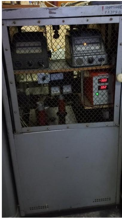
Рисунок 18 – Модуль управления энергией электронов в потоке
