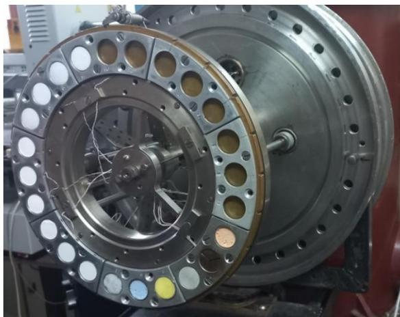
Рисунок 15 – Образцы, закреплённые на поворотном столике 26
