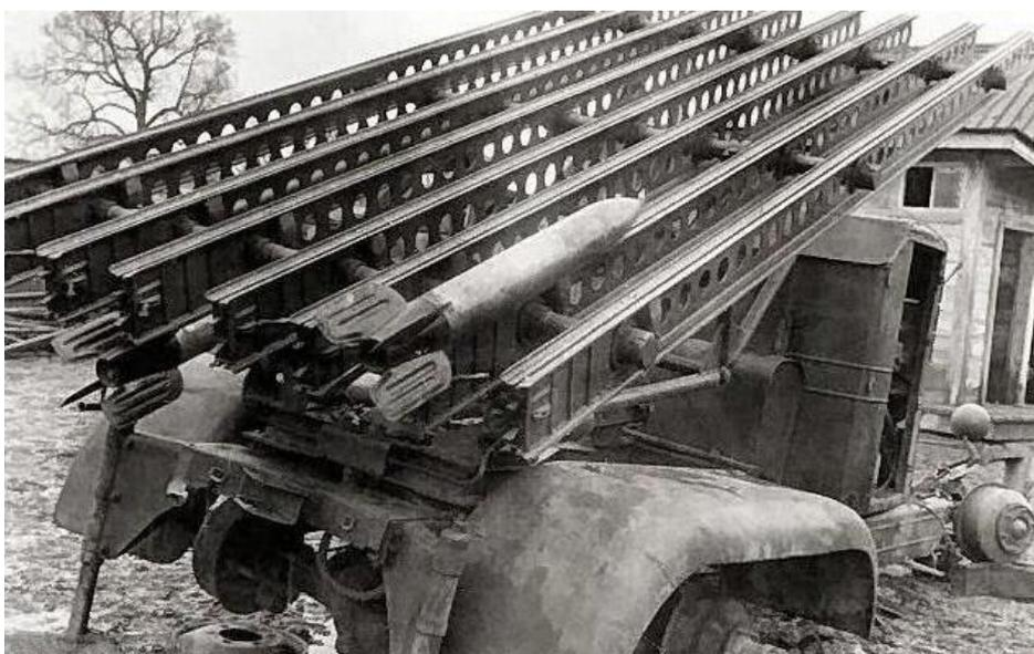
Рисунок 1.3 – Направляющие минометной установки БМ-13
