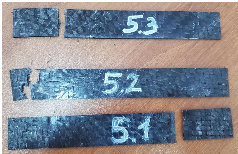
Рисунок 32 – Фото образцов группы №5 после испытаний
