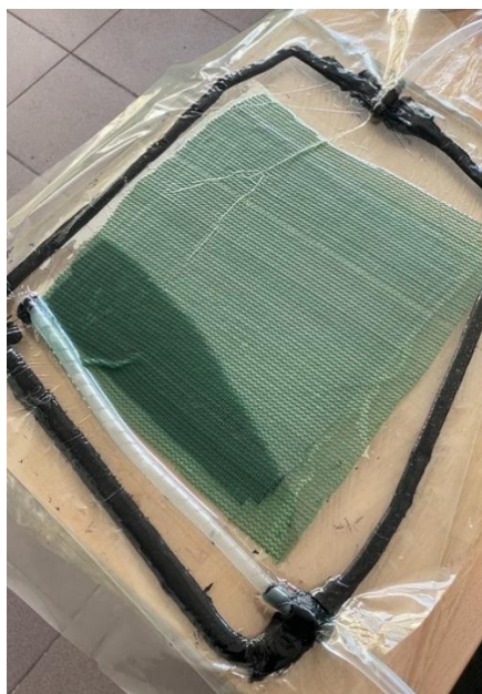
Рисунок 5 – Процесс вакуумной инфузии: а) начало процесса; б) конец процесса
