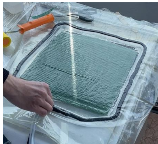
Рисунок 4 – Создание вакуумного пакета: а) до включения насоса; б) после включения насоса
