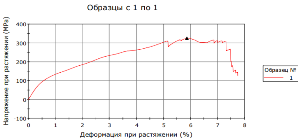
Рисунок 17 – Диаграмма деформирования образца №1.1
