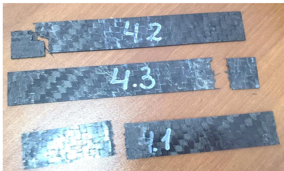
Рисунок 29 – Фото образцов группы №4 после испытаний
