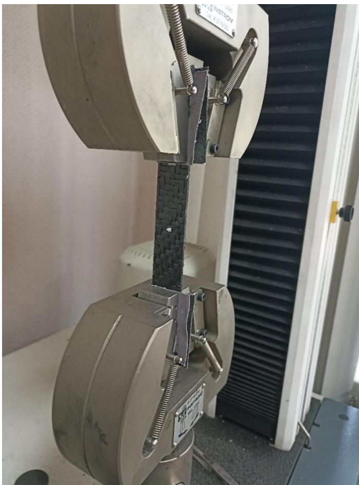
Рисунок 15 – Процесс проведения испытаний на растяжение
