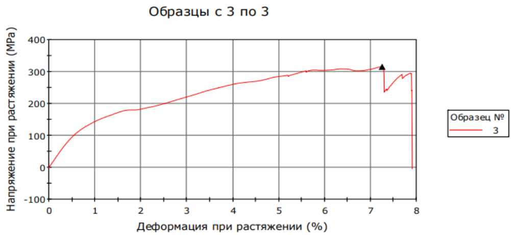
Рисунок 19 – Диаграмма деформирования образца №1.3
