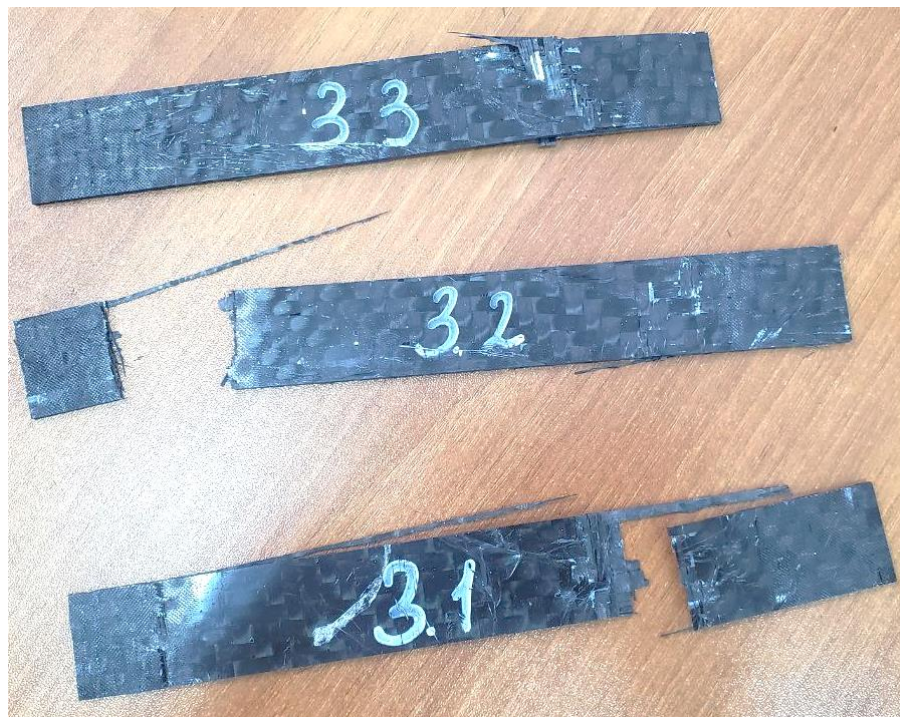
Рисунок 26 – Фото образцов группы №3 после испытаний
