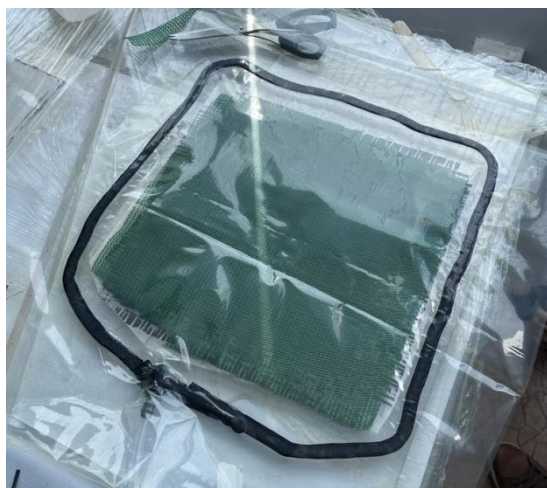
Рисунок 4 – Создание вакуумного пакета: а) до включения насоса; б) после включения насоса
