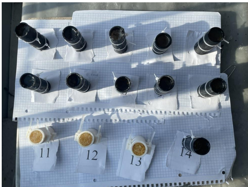
Рисунок 2 – Процесс производства образцов из эпоксидной смолы
