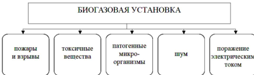
Рисунок 8 – Основные опасные факторы при эксплуатации биогазовых установок
