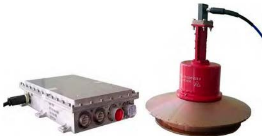
Рисунок 22 – Внешний вид высокоскоростного передатчика ПРД-3 и антенного устройства [20]
