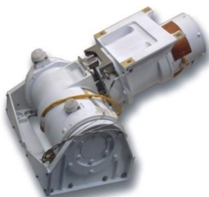
Рисунок 26 – Внешний вид поворотного-крепежного устройства СБ [21]
