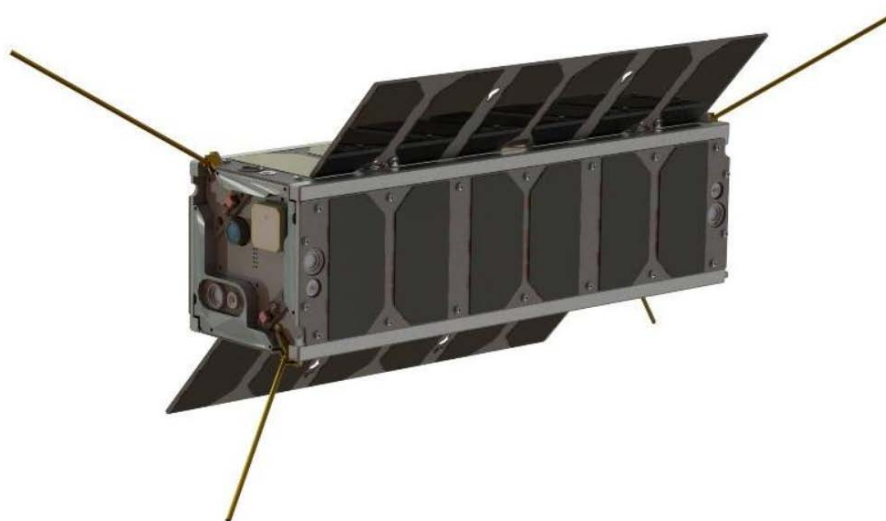
Рисунок 1 – Внешний вид наноспутника CubeSat 3U [2]
