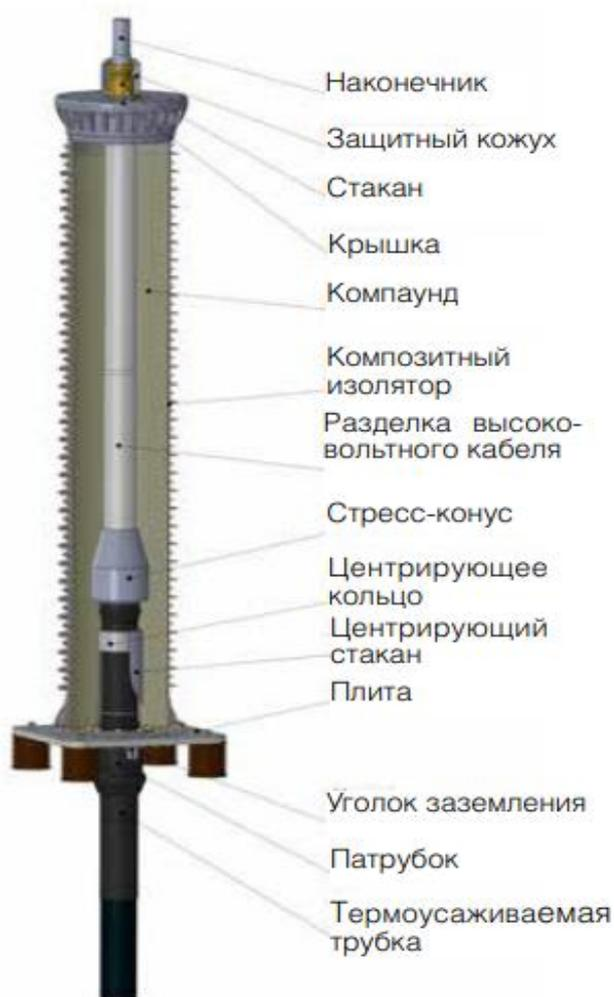
Рисунок 35 – Концевая муфта МКВ
