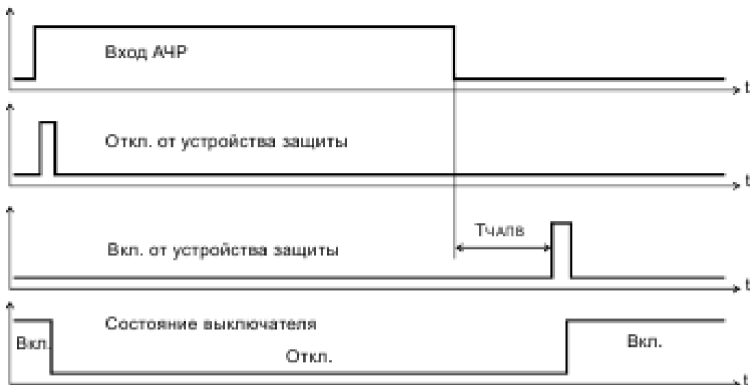
Рисунок 21 – Принцип работы АЧР и ЧАПВ при «внутреннем режиме ЧАПВ»
