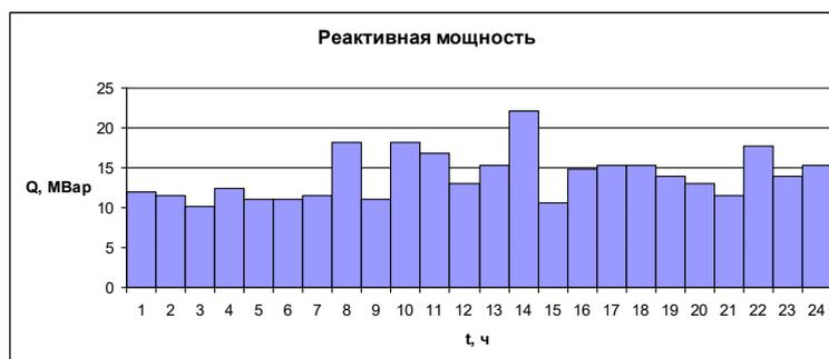
Рисунок 3 – Суточный график реактивной нагрузки города Алдан
