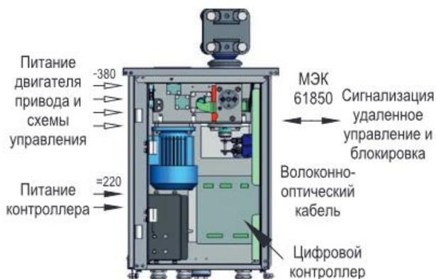
Рисунок 14 – Общий вид привода ПД-11КУХЛ1
