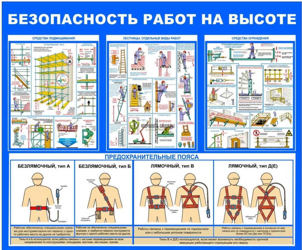
Рисунок 8 – Плакат безопасность работ на высоте
