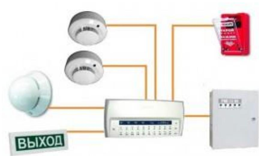
Рисунок 7 - Система оповещения и управления эвакуацией
