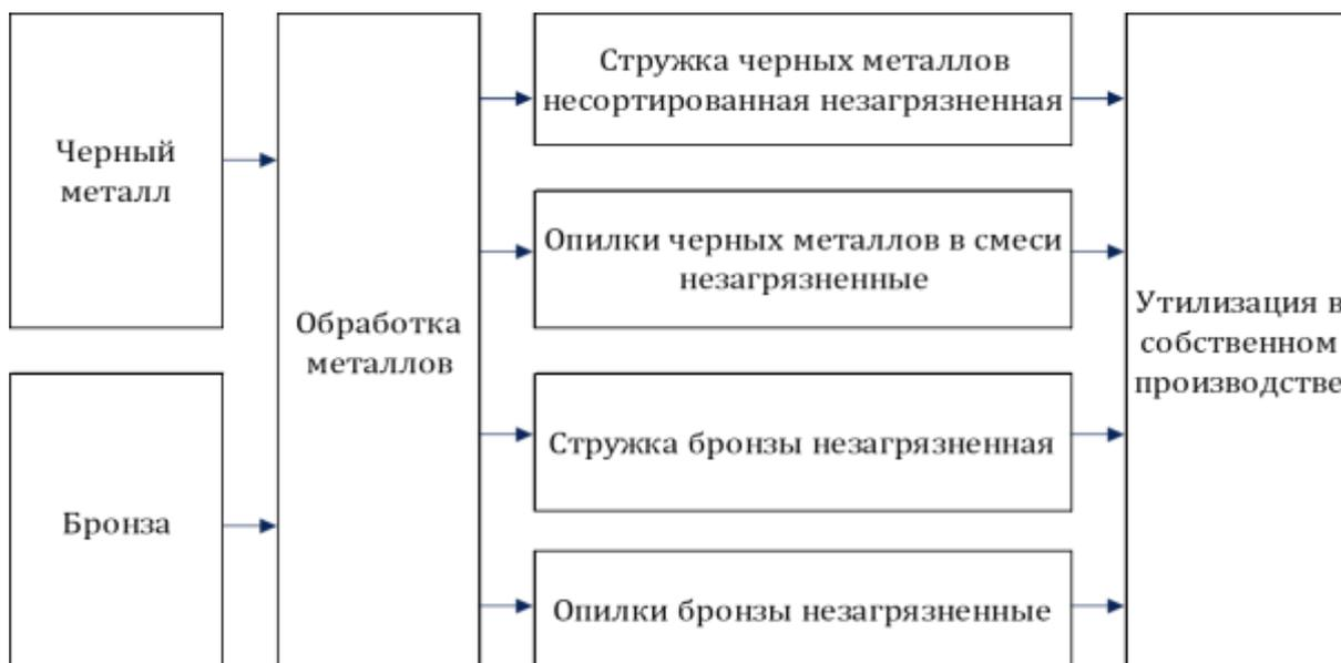
Рисунок А.4 - Образование отходов черного металла, бронзы и их утилизация в собственном производстве
