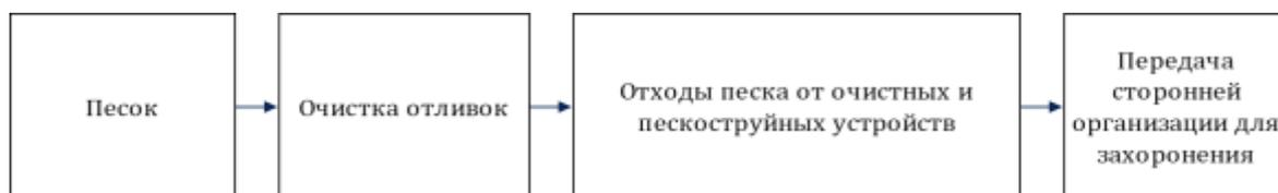
Рисунок А.9 - Скопление песка и его передача сторонней организации для захоронения
