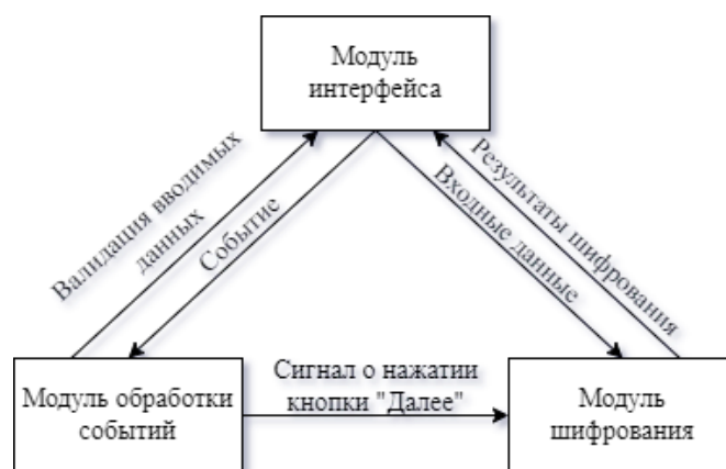
Рисунок 11 – Взаимодействие функциональных модулей программы
