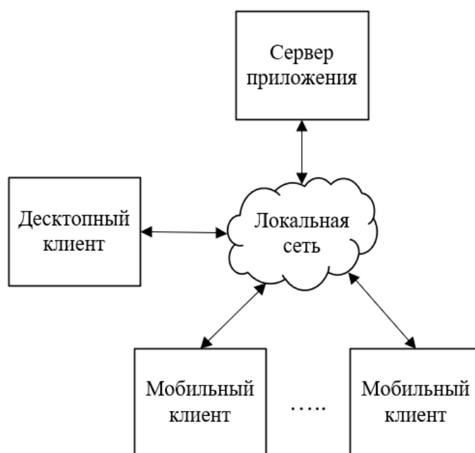
Рисунок 2.1 – Схема клиент-серверной архитектуры
