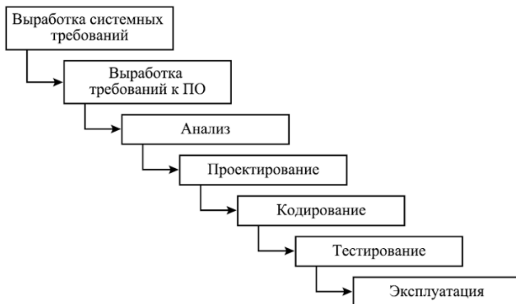
Рисунок 15 – Схема каскадной модели
