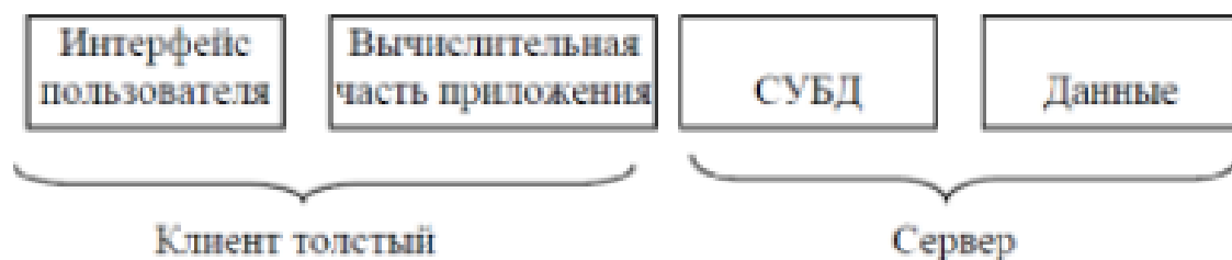
Рисунок 18 – Схема архитектуры «Толстый» клиент
