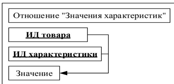
Рисунок 40 – Функциональные зависимости отношения «Значения характеристик»
