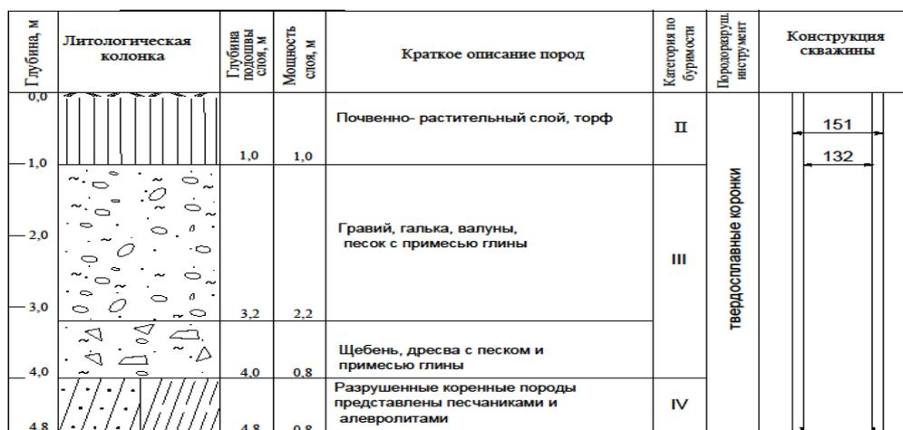
Рисунок 3 – Конструкция проектируемых скважин
