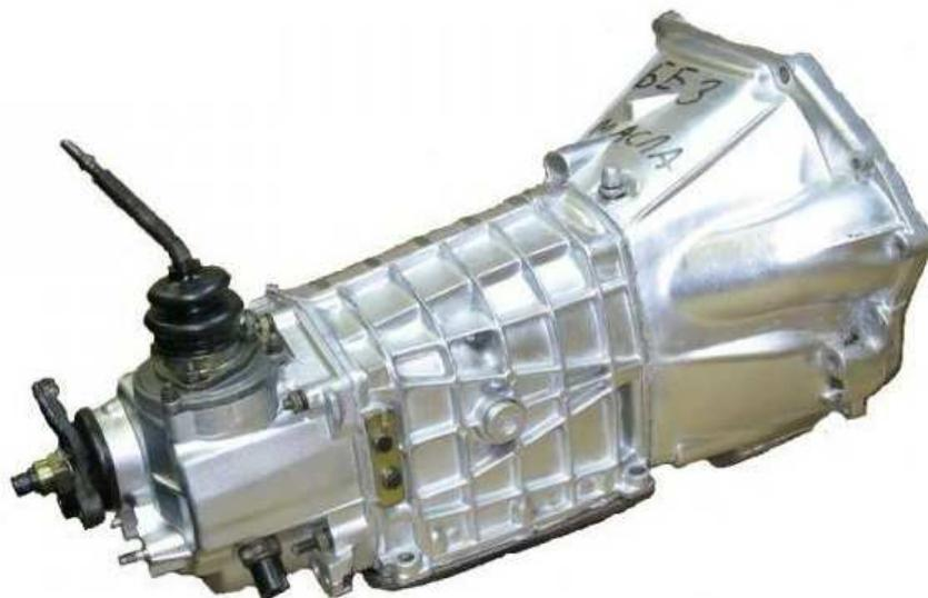
Рисунок 15 – Коробка передач автомобиля ВАЗ-2107
