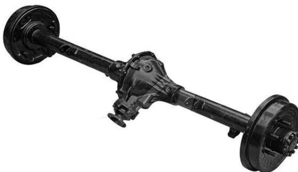
Рисунок 17 – Задний мост и редуктор автомобиля ВАЗ-2107
