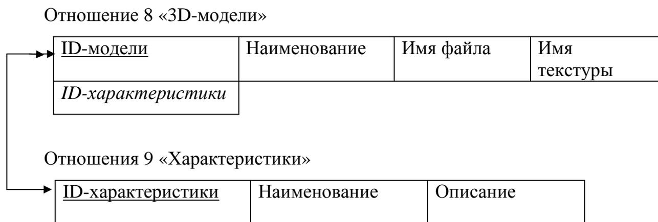
Рисунок 42 – Отображение связи «Характеристики – 3D-модели»
