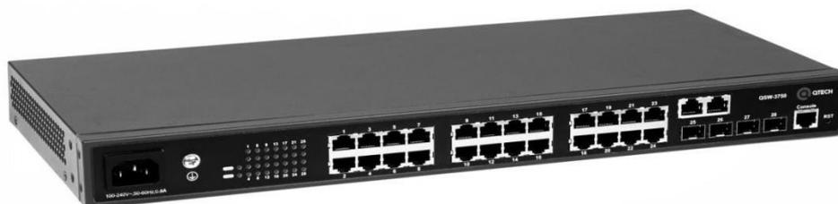
Рисунок 11 – Коммутатор Qtech QSW-3750-28T-AC
