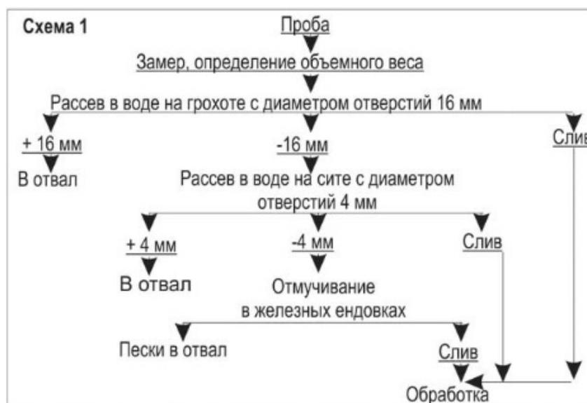
Рисунок 5 - Схема обработки пробы
