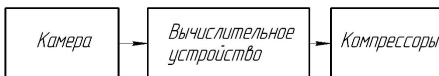
Рисунок 24 – Структурная схема работы системы центровки положения сферы в емкости
