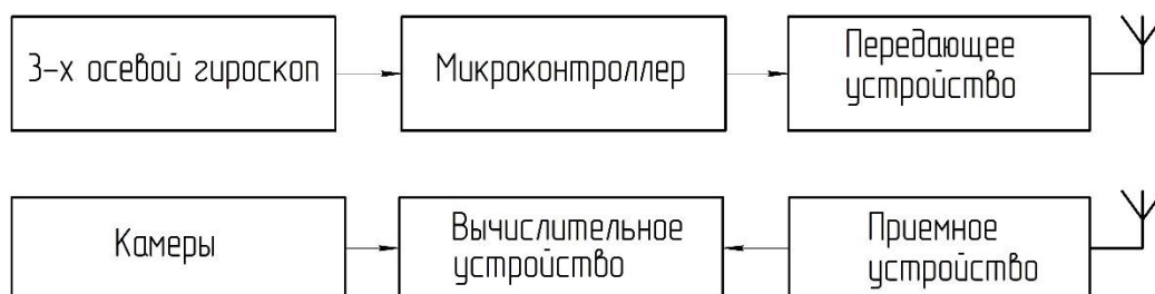
Рисунок 18 – Структурная схема устройства определения пространственного положения спутника на испытательном стенде
