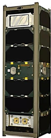
Рисунок 1 – Первый спутник Амурского госуниверситета и Дальневосточного федерального округа: CubeSat 3U «АмурСат» («АмГУ-1»)
