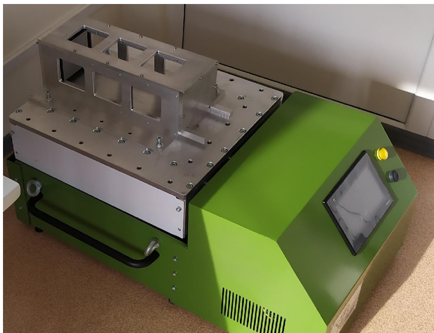
Рисунок 34 – Изготовленный ИТПК с затянутыми резьбовыми соединениями и установленный на вибростенд
