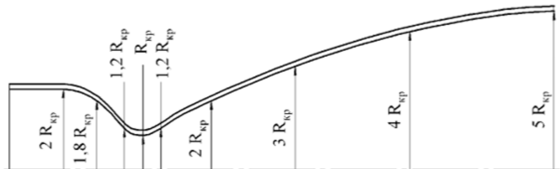
Рисунок 2.2 – Расчетные сечения камеры сгорания [16]
