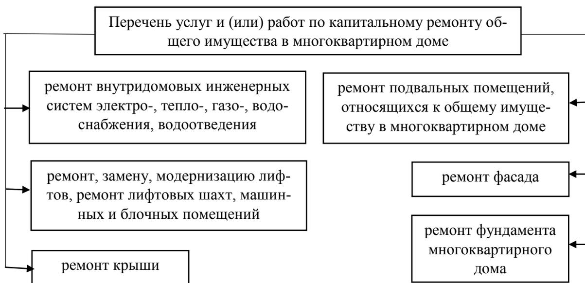
Рисунок 1 – Виды работ, входящих в капитальный ремонт многоквартирного дома
