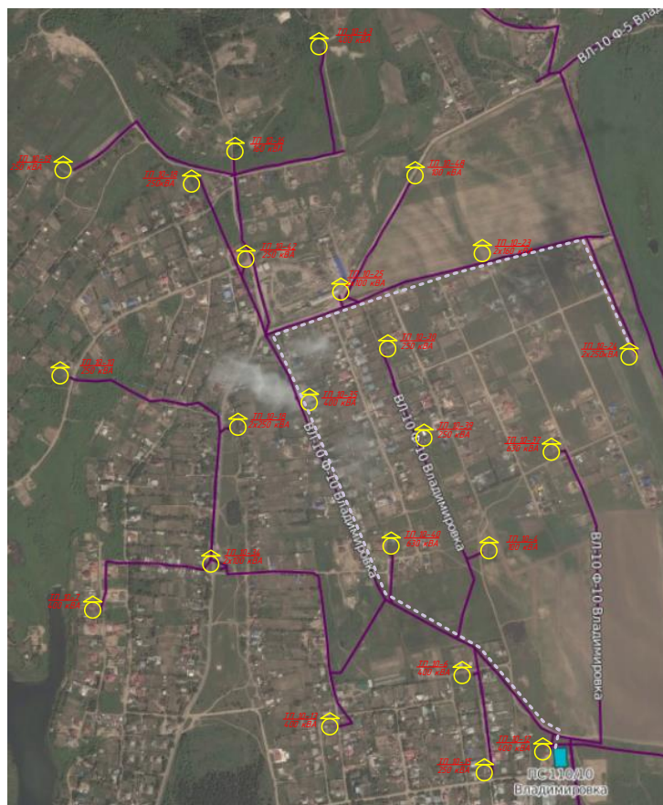
Рисунок 6 – Конфигурация распределительной сети 10 кВ (Вариант 1)
