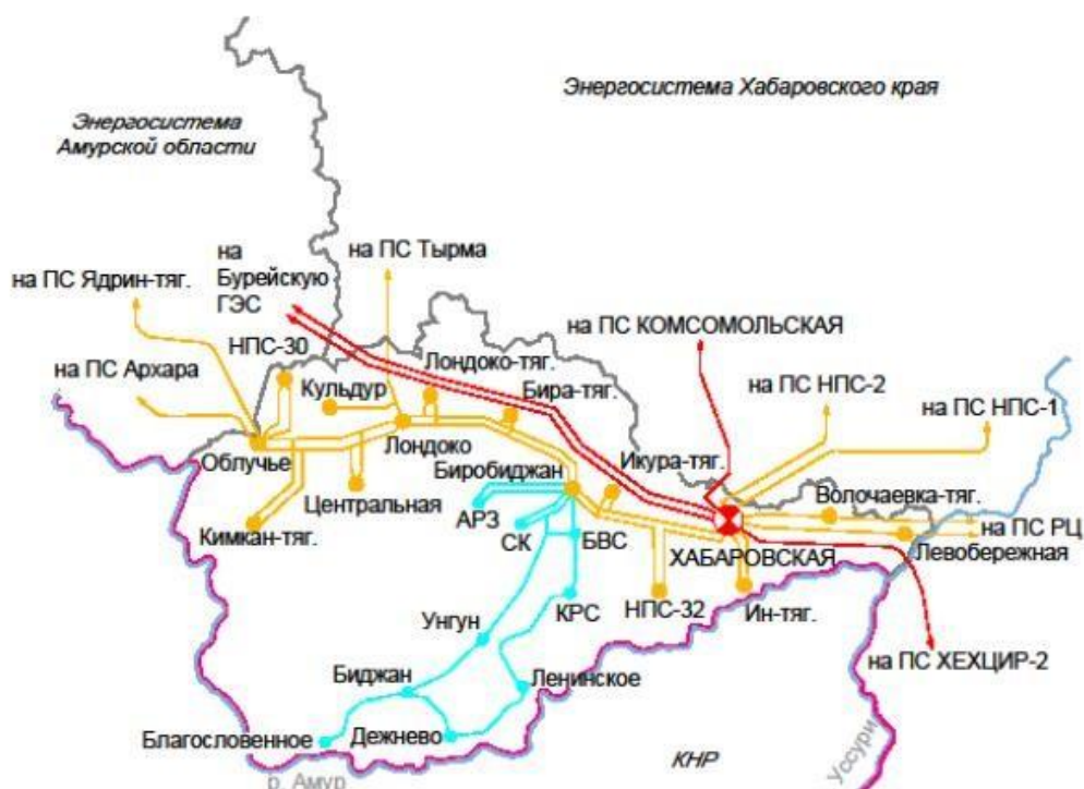
Рисунок 9 – Карта-схема размещения линий электропередачи, подстанций напряжением 110 кВ и выше энергосистемы Еврейской АО.
