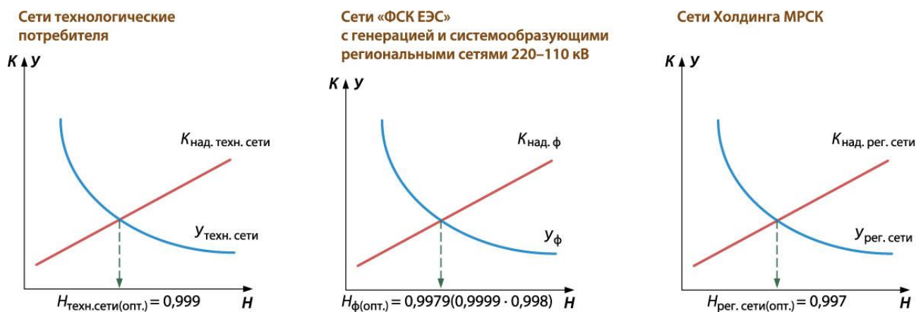
Рисунок 1 - Принципиальный характер изменения составляющих капитальных вложений в надежность электрических сетей ( K_{над.} ) и ущерба у потребителей ( U ) от перерывов в электроснабжении.
