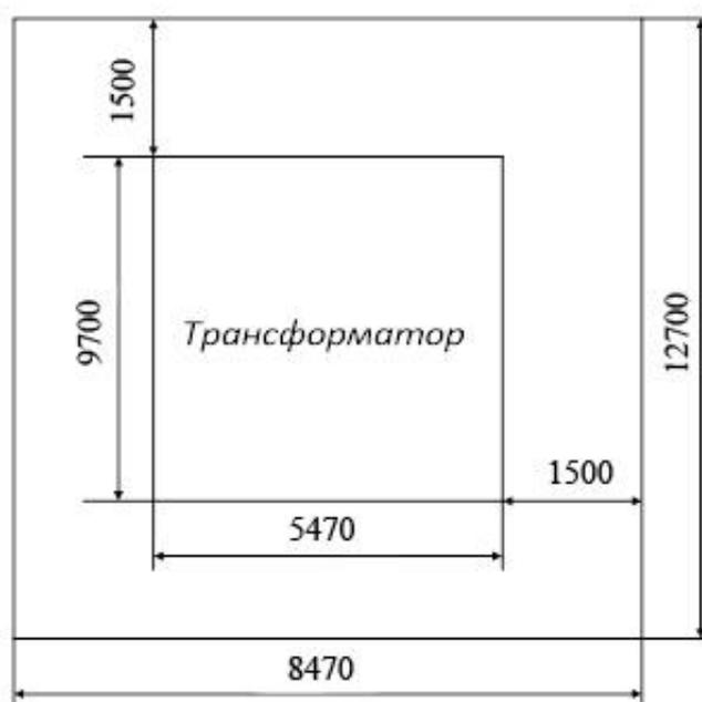
Рисунок 7.1 – Габариты трансформатора и маслоприемника
