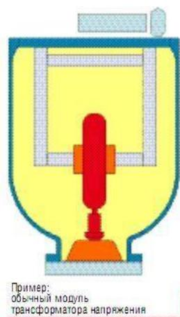
Рисунок 10 – Модуль трансформатора напряжения
