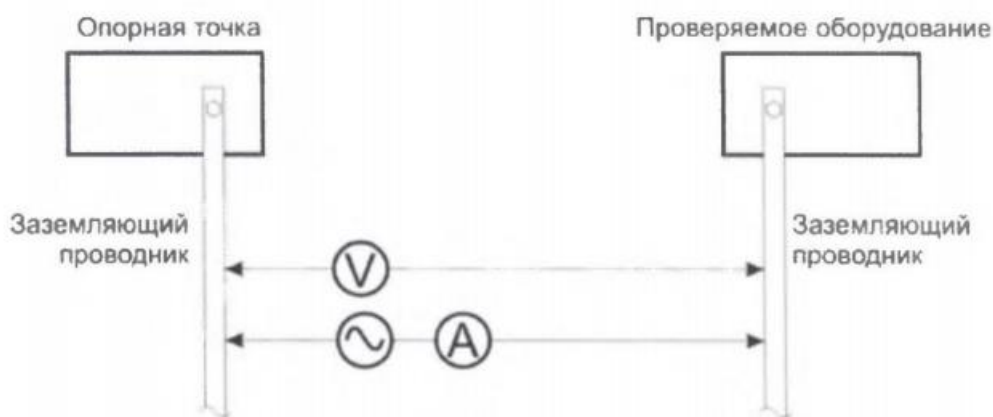
Рисунок 1 – Схема измерения сопротивления металlosвязи
