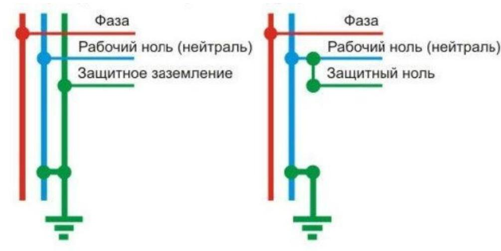
Рисунок 33 – Схема заземления и зануления
