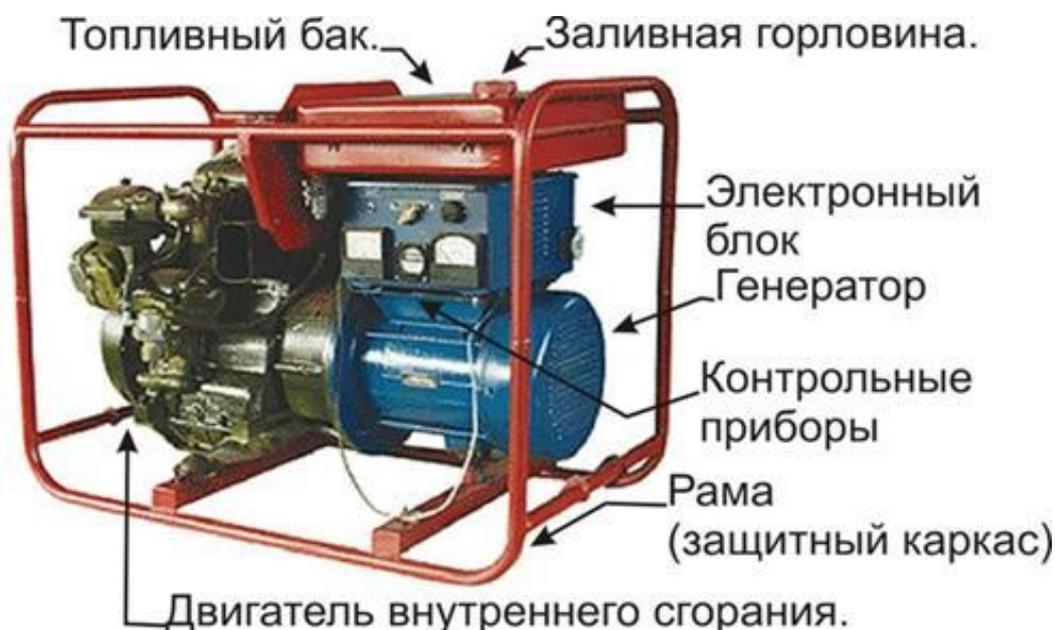
Рисунок 5– Основные компоненты дизельного генератора
