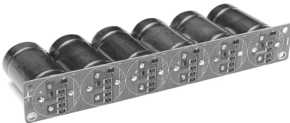
Рисунок 1.17 – Батарея из ионисторов
