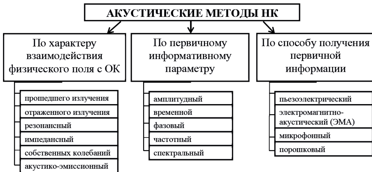
Рисунок 8 – Классификация акустических методов контроля [8]
