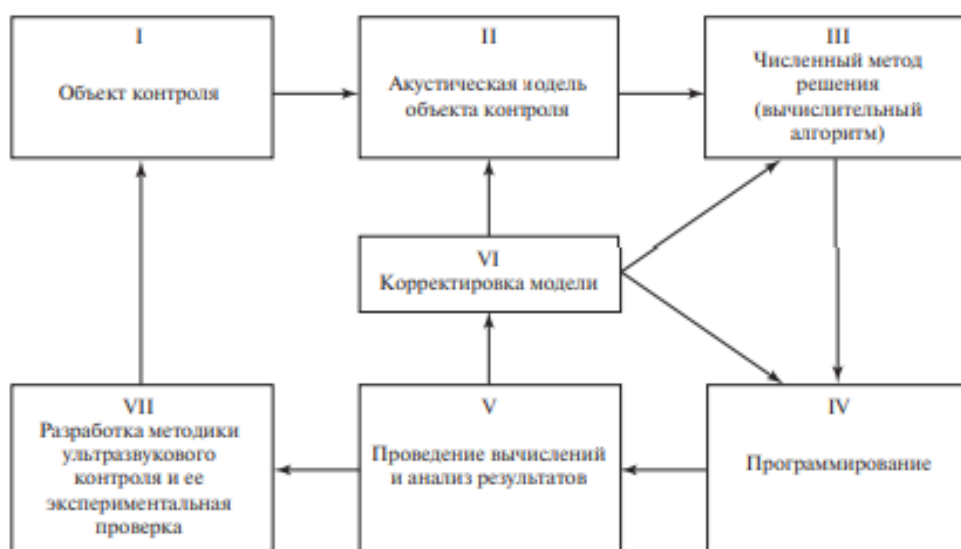
Рисунок 21 – Схема вычислительного эксперимента [2]
