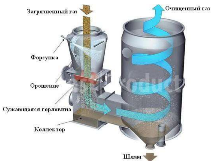
Рисунок 4 – Скруббер Вентури
