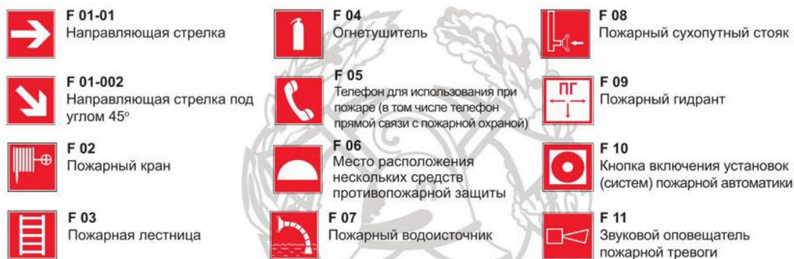
Рисунок 10 – Сигнальные знаки пожарной безопасности
