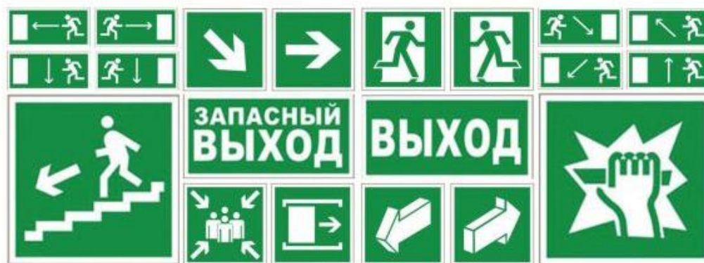
Рисунок 9 – Эвакуационные знаки пожарной безопасности
