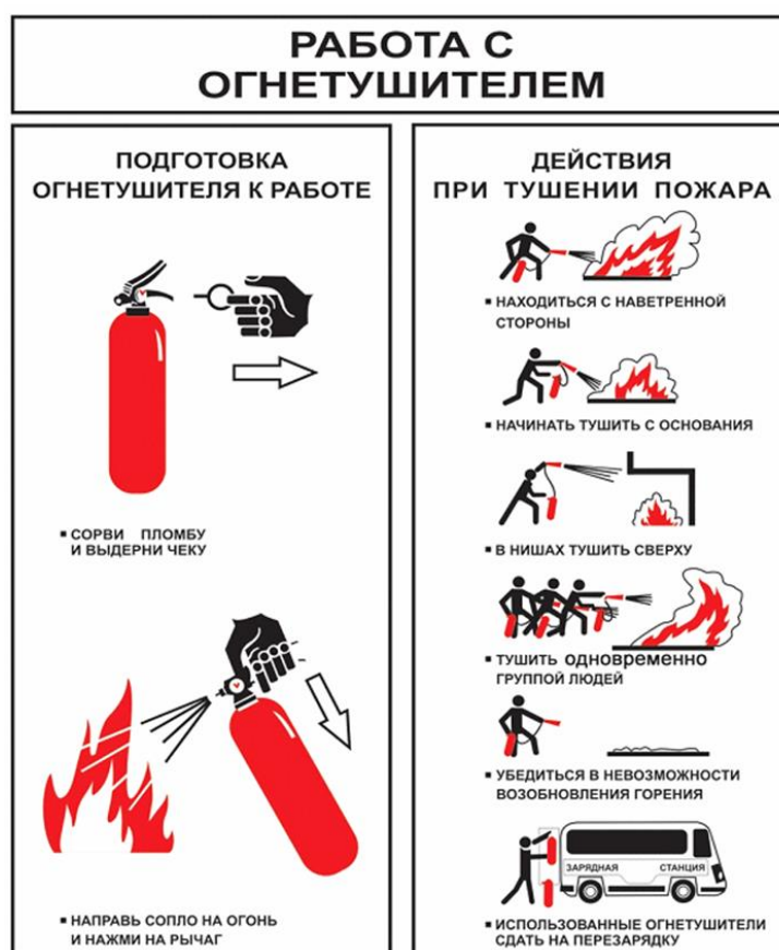
Рисунок 2 – Порядок работы с огнетушителем
