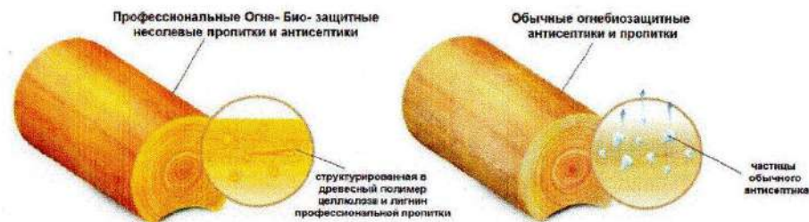
Рисунок 6 – Наглядная схема работы современных и устаревших принципов защиты древесины
