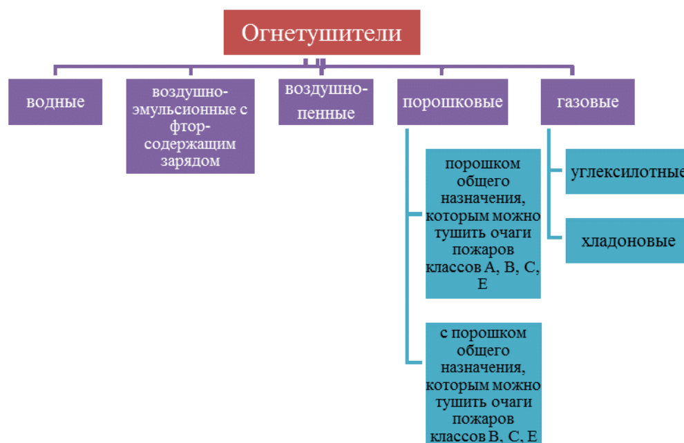
Рисунок 3 – Классификация огнетушителей от применяемого ОТВ [1]
