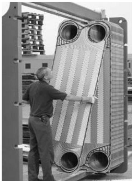
Рисунок 4 – Пластинчатый теплообменник
