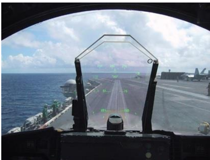
Рисунок 2 – Проекционный дисплей, установленный в истребителе
